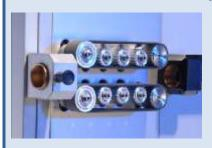
Pression de contact intelligente Les unités de transport par courroies sont équipées du système de contrôle électronique Metzner « Vario-Press ». Avec ce système innovateur, la pression de contact est ajustée en fonction de la force de dégainage en une fraction de seconde, c'est-à-dire un maximum de pression au moment de la traction, une pression de contact réduite durant le dégainage et une pression de contact minimale pendant le transport du matériel.
