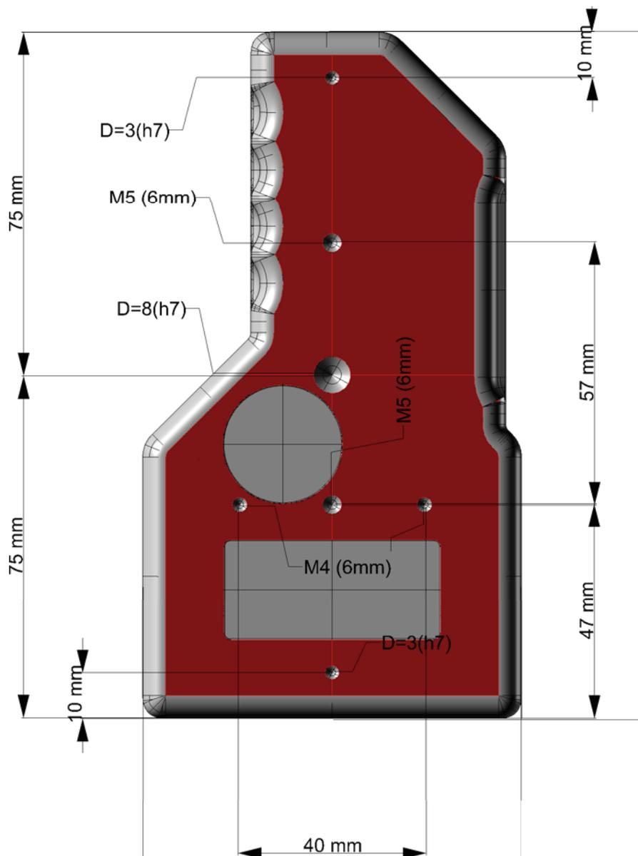
Maßzeichnungen für den Einbau der Geräte in Prüfständen finden Sie auch im Internet unter [www.alluris.de](http://www.alluris.de).
